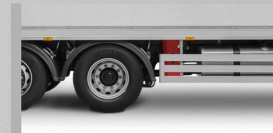
Sui veicoli con configurazioni degli assi 6x2, facoltativamente l'asse posteriore può essere sollevato quando il veicolo non è caricato. Ciò impedisce l'usura superflua dei pneumatici. Quando si ferma il veicolo per caricare, l'assale si abbassa automaticamente grazie alla tecnologia Auto-Drop.
