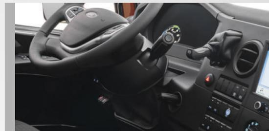
I veicoli da 450 CV sono dotati di cambio automatizzato a 16 velocità, mentre i veicoli da 330 CV offrono un cambio automatizzato a 9 velocità. Il moderno software della centralina del cambio aiuta il veicolo a selezionare automaticamente la marcia più appropriata, massimizzando sia il risparmio di carburante che le prestazioni.
