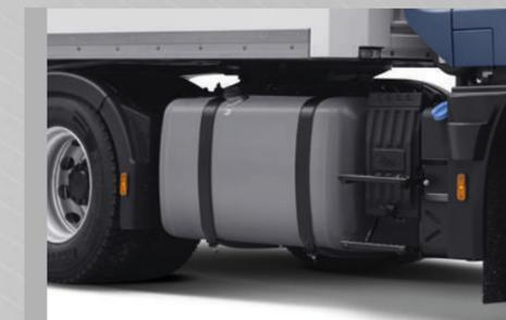
Sul 4x2, è possibile aggiungere un ulteriore serbatoio carburante di 450 litri al serbatoio di serie di 600 litri 4x2.
