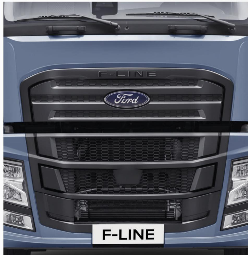
In caso di danneggiamento, il paraurti anteriore modulare permette la sostituzione solo della parte danneggiata, garantendo riparazioni rapide ed economiche.
