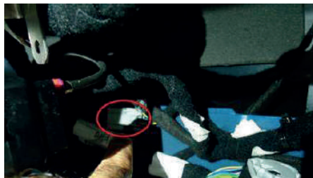
Connettore elettrico sul tetto
