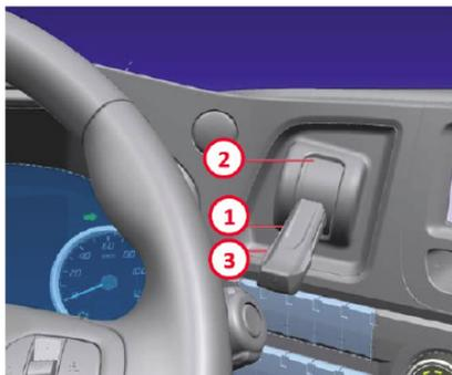
Portare la leva del freno di stazionamento in posizione 1 .
