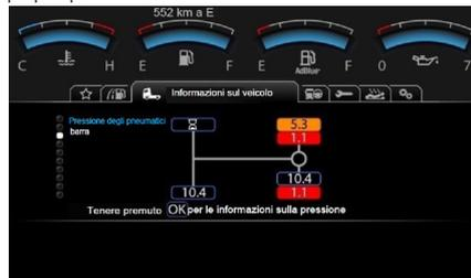
Fermare il veicolo in sicurezza, ispezionare i pneumatici e gonfiarli alla pressione corretta se la spia di bassa pressione dei pneumatici è accesa. Questo sistema non sostituisce le corrette procedure di manutenzione degli pneumatici.
