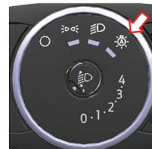
Quando il controllo dell'illuminazione è in posizione automatica dei fari, gli anabbaglianti si accendono automaticamente al tramonto e il sensore rileva che il livello di illuminazione ambientale non è sufficiente.
