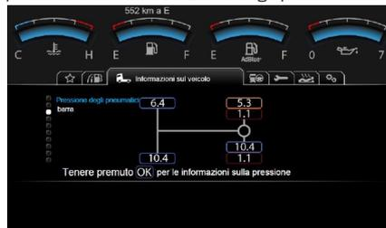
È possibile visualizzare la temperatura degli pneumatici premendo a lungo il tasto OK sul volante durante la visualizzazione della pressione degli pneumatici.
