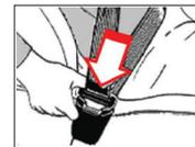
Premere il pulsante rosso sulla fibbia per rilasciare la cintura di sicurezza. Quindi, rilasciare lentamente la cintura, per permettere che si avvolga completamente sulla bobina.
