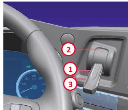
Dopo aver portato la leva in posizione 1, controllare se il veicolo con semirimorchio si muove premendo la leva e tirandola verso il basso (posizione 3). Quindi, riportare la leva in posizione di parcheggio (posizione 1). Scendere poi dal veicolo e azionare il freno di stazionamento del rimorchio.
