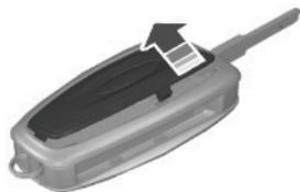
3. Rimozione del coperchio della batteria.
