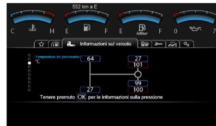
È necessario assicurarsi che la pressione degli pneumatici sia corretta anche se la spia di bassa pressione degli pneumatici non è accesa. Il sistema di monitoraggio della pressione e della temperatura degli pneumatici è dotato di una spia di guasto del sistema che avverte quando il sistema non funziona correttamente. La funzione dell'indicatore di guasto e della spia di bassa pressione degli pneumatici è comune.
