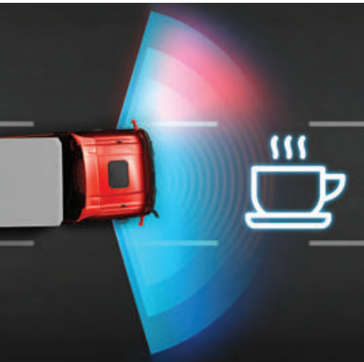
DAS - SISTEMA DI ALLARME CONDUCENTE Utilizza un'analisi effettuata con l'ausilio della telecamera anteriore e del sensore angolo di sterzo del sistema EBS per rilevare la distrazione del conducente e ridurre i potenziali rischi con avvisi tempestivi.
