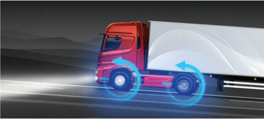
ASSISTENZA ALLA PARTENZA IN SALITA Impedisce al veicolo di slittare alla partenza e agevola la manovra durante la frenata o la guida su strade sdruciolevoli.
