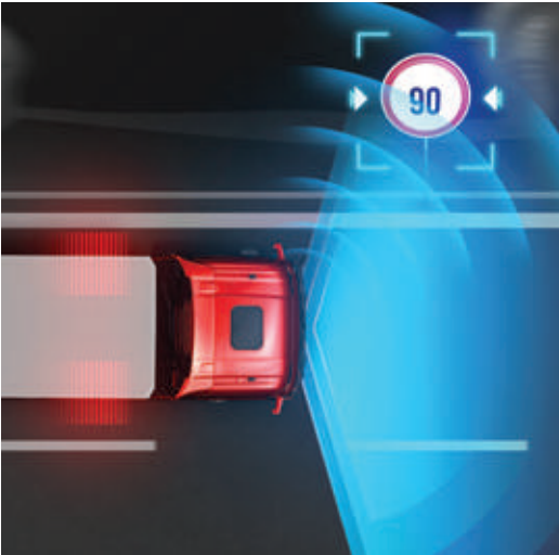
TSR - RICONOSCIMENTO DEI SEGNALI STRADALI Riconosce i limiti di velocità utilizzando i dati della telecamera e del navigatore, avvisa in caso di superamento e interviene quando necessario.
