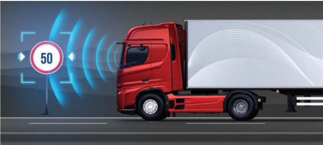
LIMITATORE DI VELOCITÀ Consente di risparmiare carburante impostando un limite di velocità e rispettando i limiti indicati sulla strada.
